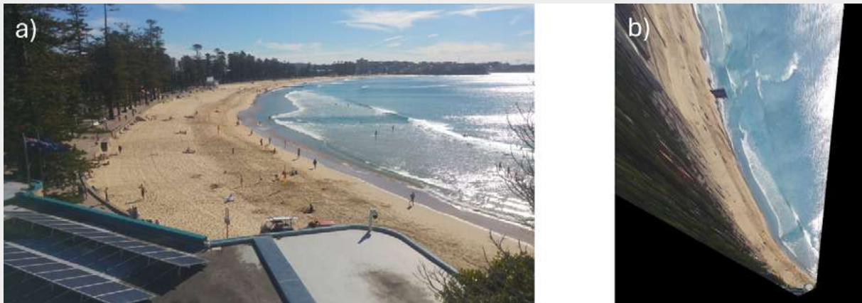
Figure 8 | Ci-dessus | (a) Image oblique alignée. Coordonnées des pixels (U ;V) ; (b) image rectifiée, projetée dans le plan horizontal, vu de dessus. Coordonnées des pixels (x,y,z) – exemples du tutoriel de Mitchell Harley.
